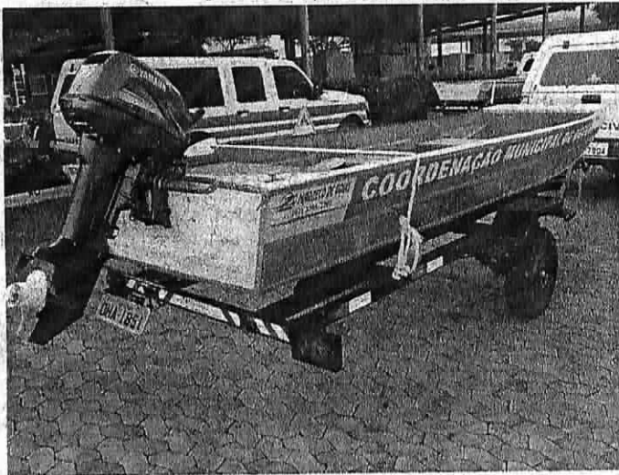
Barco de Alumínio (fundo chato, para áreas alagadas) + Motor de popa 15 HP + Reboque para barco de alumínio
